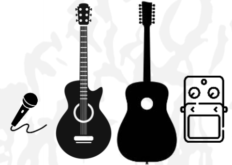
Andi Mikrofon an XR 18 (Ch 4) Gitarren 2x Klinke an Effektgerät Strom für Effektgerät Effektgerät Klinke an XR 18 (Ch 2)
